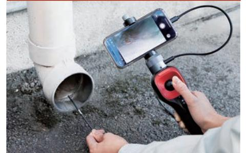
先端部はIP67の防水・防塵性能を備えているため、水回りでの使用も安心です。
